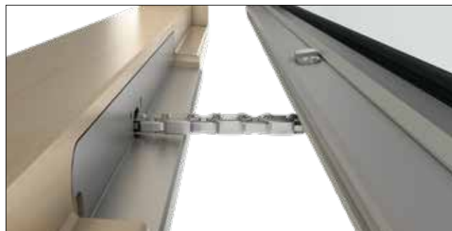
El-motor. El-motoren er indbygget i karmen og er derfor ikke synlig, når vinduet er lukket. Kan computerstyres og bruges i huse med naturlig ventilation. Fås i 3 forskellige kædelængder med en åbning på 60mm, 210mm eller 440mm.
