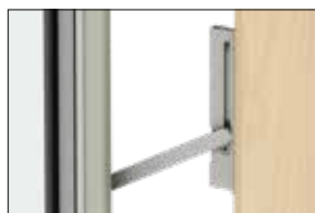
Låsbar åbningsbegrænser. Må ikke anvendes i brandredningsåbninger. Fås ikke til topvændeinduer og skydedøre.
